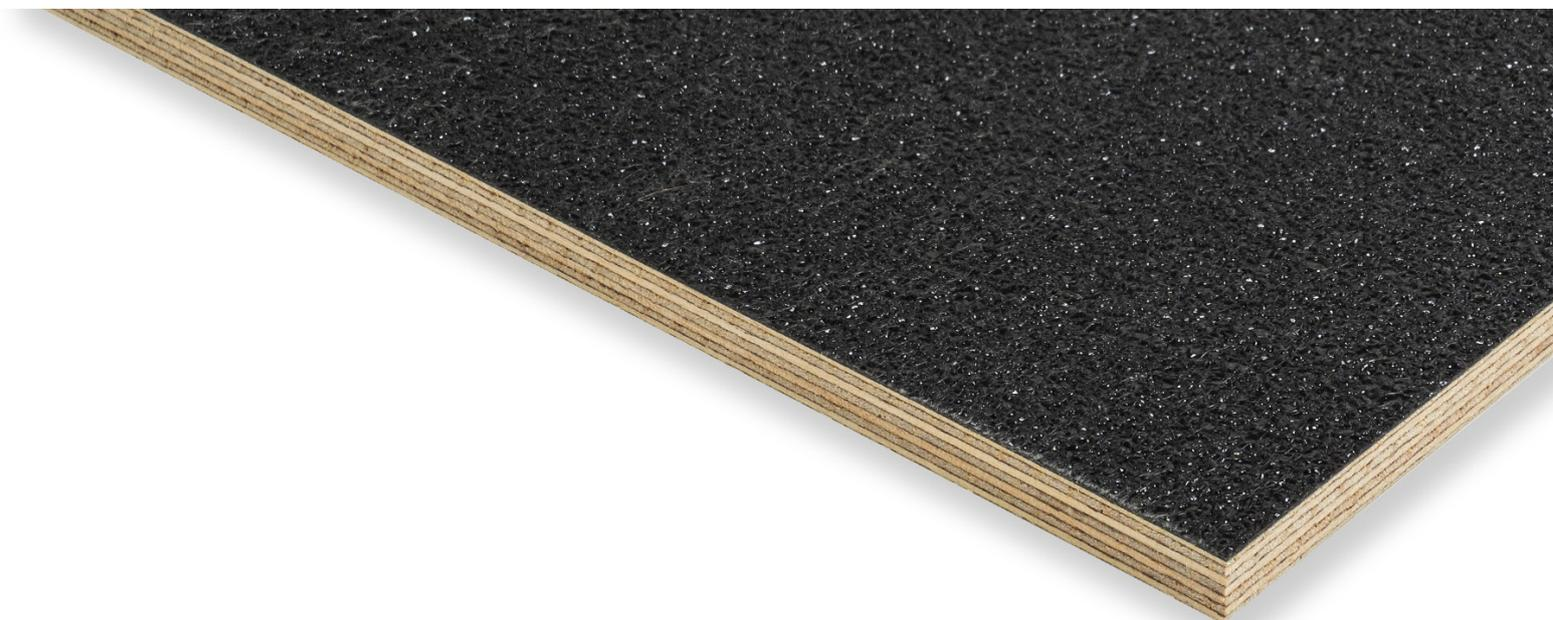
KoskiGrip es un contrachapado resistente de construcción de abedul o combi, recubierto con un acabado especial. La dura pero a la vez elástica superficie ofrece muy buenas propiedades de antideslizamiento y resistencia al desgaste.
