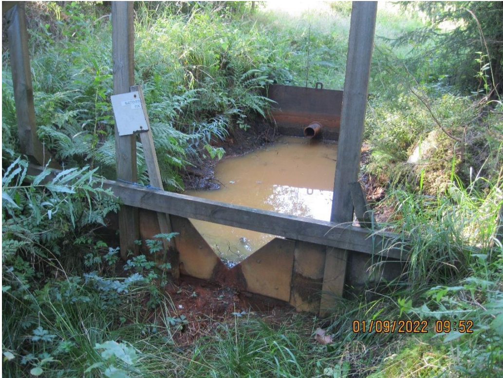
Kuva 69. Suotovesien "kokooma-allas" ja mittapato syyskuussa 2022. Kuivasta kesästä johtuen suotovesiä ei virtaa mittapadosta.
